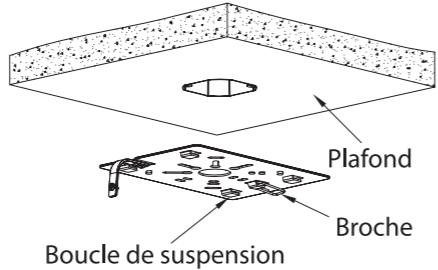
Étape 3 : Connectez le clip du luminaire à la broche de la plaque de montage pour vous assurer que le luminaire ne glissera pas et ne tombera pas. Connectez les fils de tension sortant du luminaire comme indiqué dans le schéma de câblage. Poussez la plaque de pression dans la boucle de suspension sur la plaque de montage.
